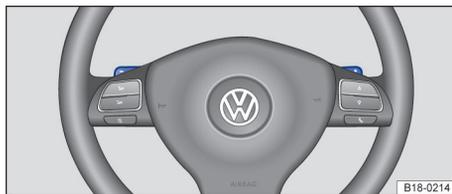
图 135 部分车型方向盘上的换挡拨片
