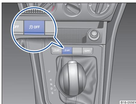
图 137 副仪表板局部图：ESP OFF 按钮开关（部分车型）
