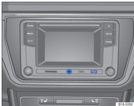
图 116 部分车型 AUX-IN 和 USB 输入端位于中控台上
