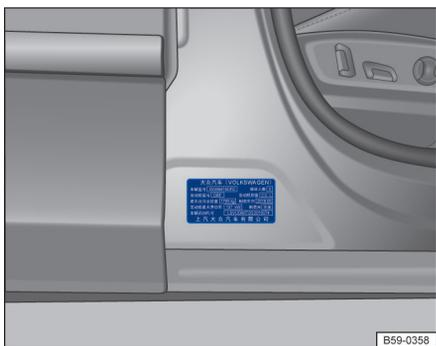
图 39 B 柱下方整车产品标牌。
