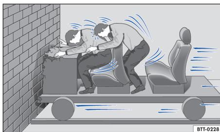
图 76 载有未系安全带的驾乘人员的汽车撞到墙上
