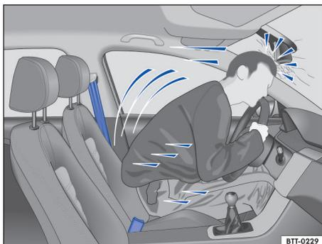
图 77 碰撞时未系安全带的驾驶员被猛烈抛向前方
