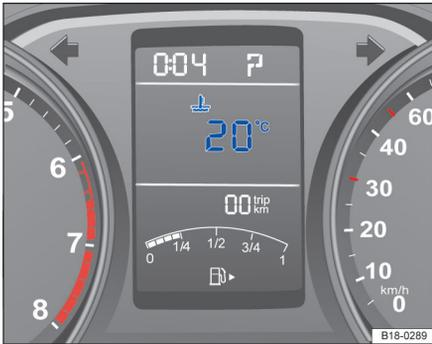
图 27 冷却液温度
