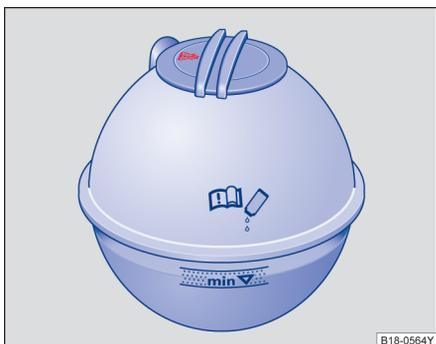
图 169 冷却液补偿容器上的液位标记
