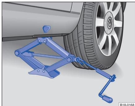
图 196 安放汽车千斤顶
