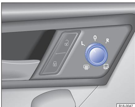
图 106 在驾驶员侧车门内：车外后视镜旋钮
