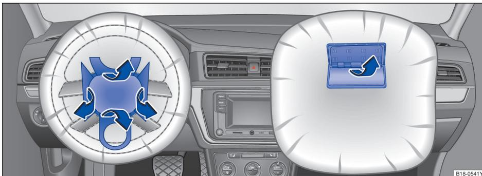
图 85 前排正面安全气囊的安装位置和膨胀范围
