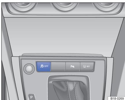
图 136 副仪表板局部图：ESP OFF 按钮开关
