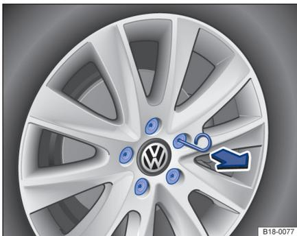
图 192 从车轮螺栓上拔下盖罩
