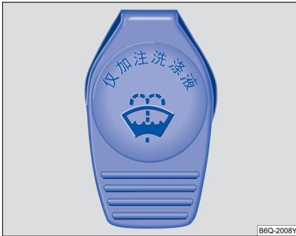
图 103 发动机舱内：车窗清洗液容器盖
