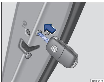
图 184 车门应急上锁装置及汽车钥匙
